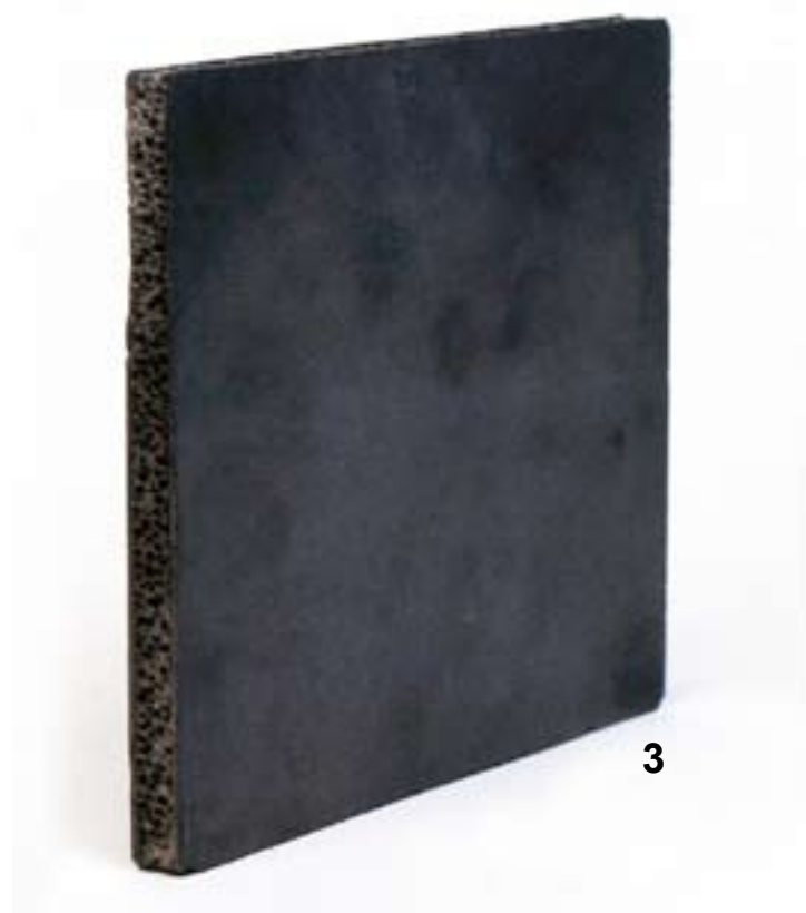
1 y 2 Filtros de espuma cerámica de la empresa Arrosi. 3 paneles sándwich LigaFill® dimensiones aprox. 180x180x10 mm
