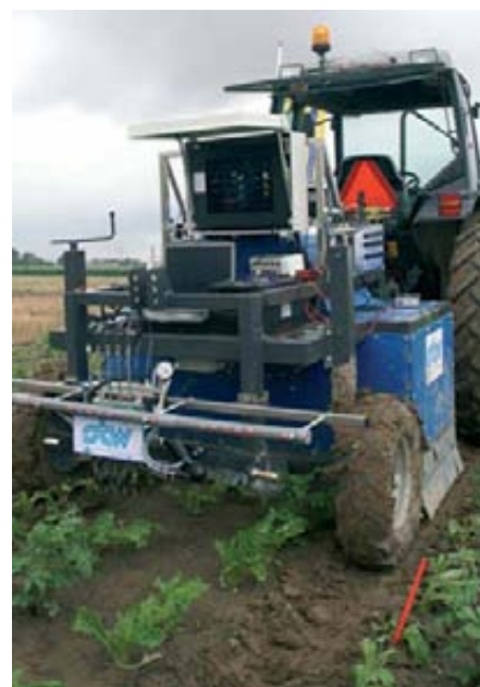
Foto 4 (izda). Identificación de plantas de patata en cultivos de remolacha mediante reflectancia espectral.
